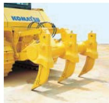
•El desgarrador con escarificadores múltiples es un desgarrador con escarificadores en paralelo, ideal para desgarrar material duro. La profundidad de desgarramiento se puede ajustar en dos etapas.
