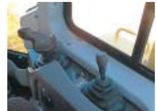
Joystick de control de la hoja y el desgarrador
