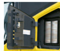
Filtro externo del aire acondicionado
